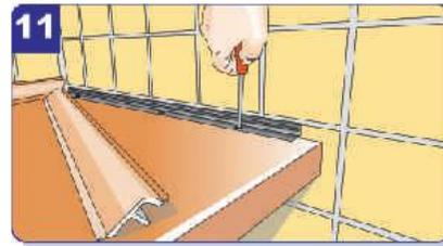
Für die Abschlussleisten ist es sinnvoll Stecksysteme, bei denen der Träger auf der Platte befestigt wird zu verwenden. Ist dies geschehen, wird das Leistenprofil von oben aufgedrückt. Für die Enden und Ecken gibt es extra Abschlusskappen.
