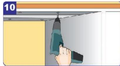
Die Arbeitsplatte wird von unten durch die Querbindung der Unterschränke fest verschraubt. Wichtig ist, dass die Unterschränke waagrecht ausgerichtet sind. Orientieren Sie sich dabei an den Stellfüßen. Bei Nichtbeachtung können sich Verschiebungen ergeben oder die Platte unter Spannung stehen.
