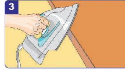
Der Umleimer wird mit einem Bügeleisen auf die offene Stirnseite aufgebügelt oder alternativ mit extra dafür vorgesehenem Kleber verklebt. Die Fronten der Abriebsplatte mit individuell gewähltem Umleimer beschichtet
