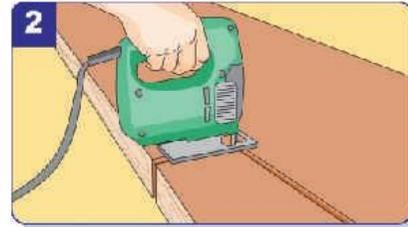
Neue Arbeitsplatte an der Verlauf der Wand anpassen und Wandvorsprünge sowie Ecken und Kanten mit der Stichsäge ausschneiden.
